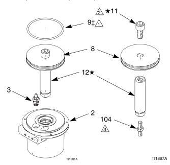
Fig. 10. Air Motor Piston
