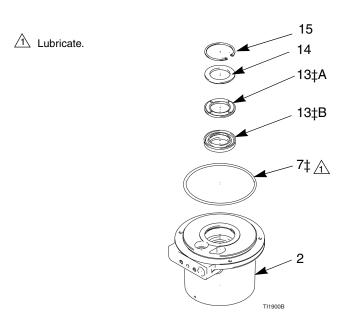
Fig. 11. Air Motor Base
