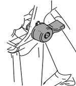
**b.** Apague el pulverizador y desconecte la fuente de alimentación.
