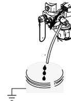
**d.** Desmonte y limpie la boquilla de pulverización GHD RAC tal como se indica en las instrucciones de la boquilla GHD RAC adjuntas.
