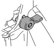
2. Apague la bomba. Cierre la válvula neumática principal de purga (sólo bombas neumáticas).
