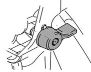
6. Abra la válvula de drenaje del fluido; prepare un recipiente para recoger el drenaje. Deje la válvula de drenaje abierta hasta que comience a pulverizar de nuevo.
