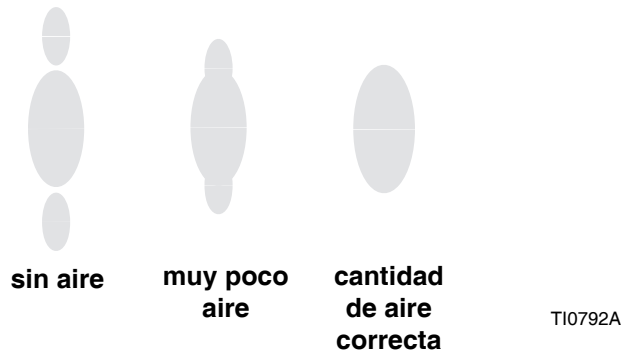
FIG. 6. Problemas del patrón de pulverización
