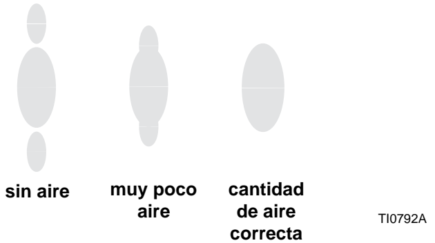
FIG. 6. Problemas del patrón de pulverización
