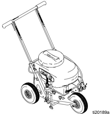
3. Regule la altura de la boquilla para ajustar el ancho de la línea (subir la altura de la boquilla produce líneas más anchas).
